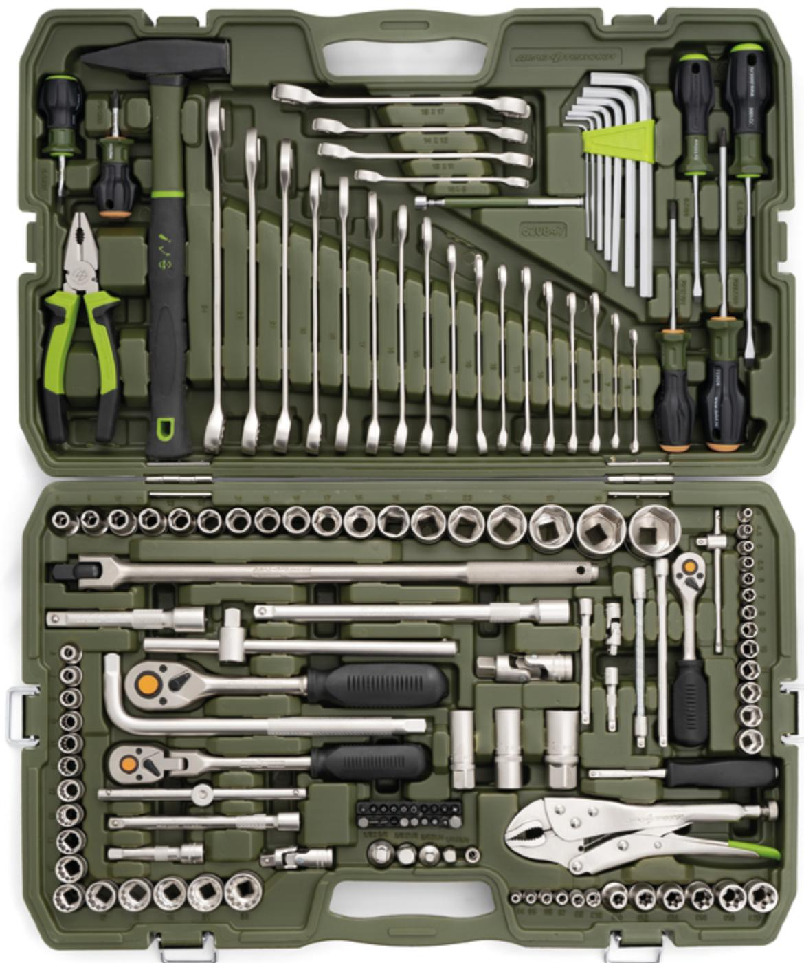
Набор включает в себя инструмент с соединительным квадратом на 1/4", 3/8", 1/2", что обеспечивает взаимозаменяемость головок и приводов любого из профилей. Таким образом увеличивается количество возможных вариантов подбора требуемой головки с учётом расположения крепежа и выбора привода необходимого размера.
